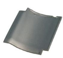
材料は陶器瓦と同じですが焼き方が違います。うわ薬を使わず炭素膜を表面に作りますので、色は渋い銀色（いぶし色）になり、炭素膜ですので、普通の陶器瓦よりも耐久性が高く長持ちします。色・形共に和風の家に使います。
