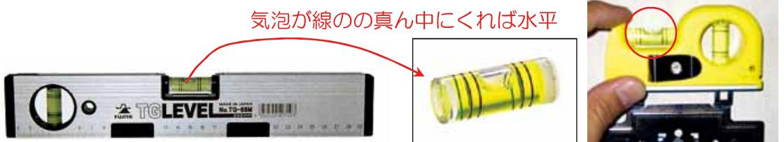
水平器がなく、床(天井)からの高さで見る場合は、床が傾いている可能性があるので寸法通りに合わすより目で見て違和感がないようにするのがポイント!
