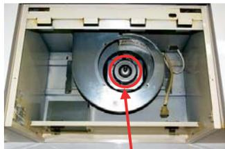
シロッコファン (IH) はばらすのが難しいかもしれませんが、下の板と前のフードが外せます、内部の赤丸がプロペラ。 →
